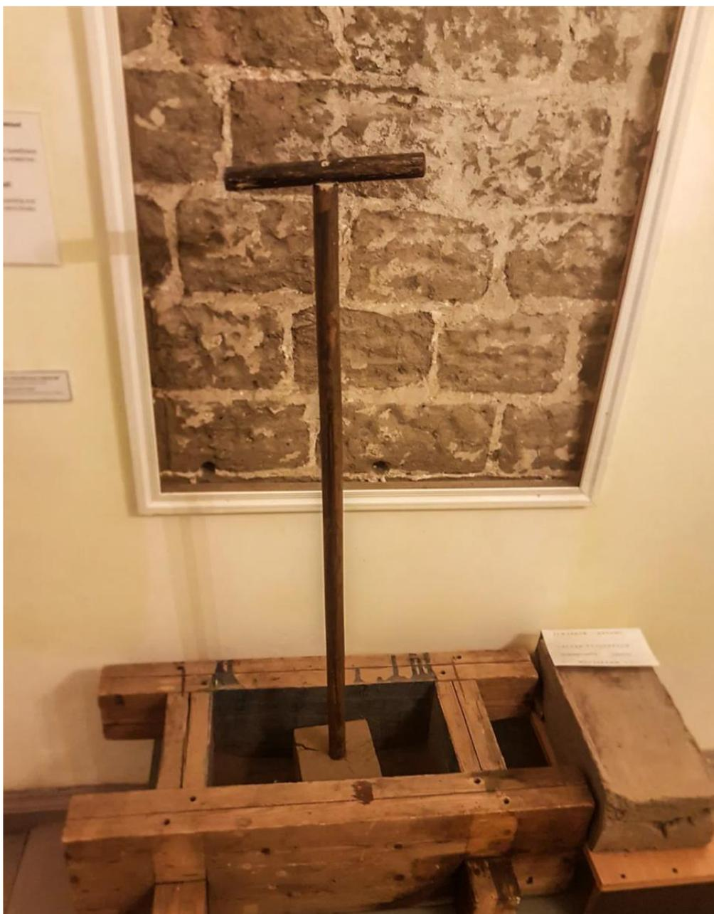
**Рисунок 34** – Из экспозиции Приоратского музея: стена с частично снятой отделкой (для демонстрации блоков), а также форма и приспособления для прессовки, сам блок ([https://zen.yandex.ru/media/novgorodskiy\\_stroitel/tehnologii-zemlebitnogo-stroitelstva-prioratskii-dvorec-i-ne-tolko-602d18bf5f462a3bfd8752ad](https://zen.yandex.ru/media/novgorodskiy_stroitel/tehnologii-zemlebitnogo-stroitelstva-prioratskii-dvorec-i-ne-tolko-602d18bf5f462a3bfd8752ad))
